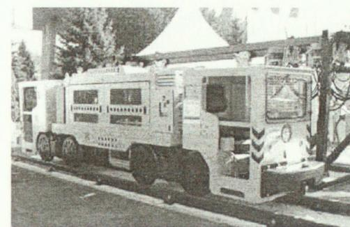
Pogon se prenosi sa hidrauličnih motora preko zupčanika do para točkova koji je povezan sa njima. Zupčanici su pričvršćeni za okvir vagona na vibracioni način putem čaura. Ovaj način povezivanja zupčanika omogućuje ravnomerno raspoređivanje težine lokomotive na sve pogonske točkove.
