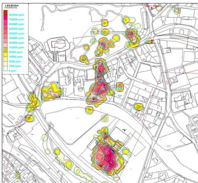
Obr. 3 Výsledky atmogeochemického průzkumu ve staré části Orlové.
