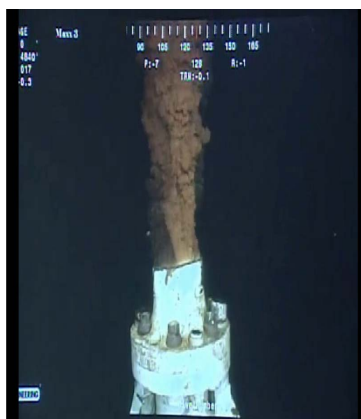
Obr. 2 Unikajúca ropa z poškodeného protierupčného uzáveru a nový BOP [2].
