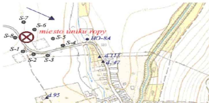
Obr. 1 Mapa územia havárie ropovodu a rozmiestnenia monitorovacích vrtov S1 až S8 v oblasti Košice – vidiek [3].
