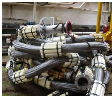
Obr. 5 Gumotextilná sacia hadica s plavákmi.
