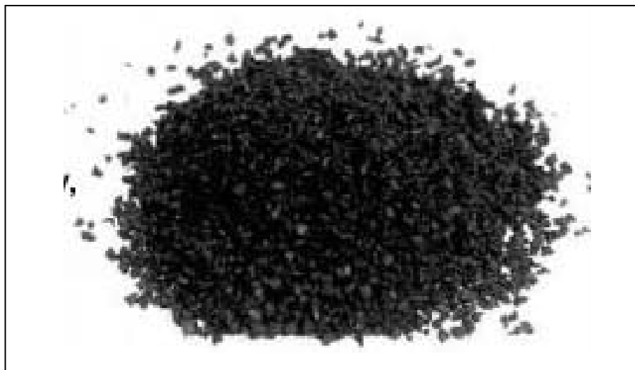
Obr. 2 Produkt recyklácie pneumatík – gumový granulát Fig. 2 Tyre recycling product – rubber granules
