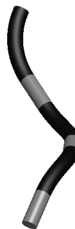
Obr. 2 Drôt vinutý okolo osi prameňa Fig. 2 The wire laid round the strand axis
